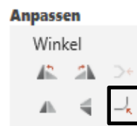
Abbildung 71: Ecken von Elementen angleichen
